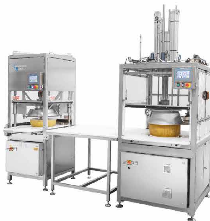
ROCK 23 LINEA DI PORZIONATURA PORZIONATRICE AUTOMATICA A PESO FISSO E VARIABILE PREDISPOSTA PER LAVORARE ANCHE IN LINEA E DISCATRICE AUTOMATICA
