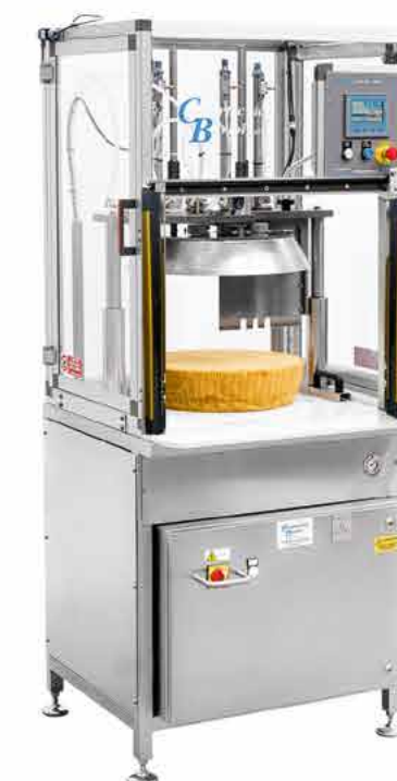
ROCK 20 PLUS PORZIONATRICE AUTOMATICA A PESO VARIABILE E FISSO, DISPONIBILE CON BARRIERE OTTICHE E STANDARD PUO' TAGLIARE TUTTI I TIPI DI FORMAGGI A PASTA DURA E SEMIDURA, REALIZZANDO PEZZI A PESO SIA FISSO CHE VARIABILE
